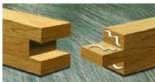
2- Assemblez les 2 éléments en appuyant ou serrant quelques secondes tout en ajustant si nécessaire.
